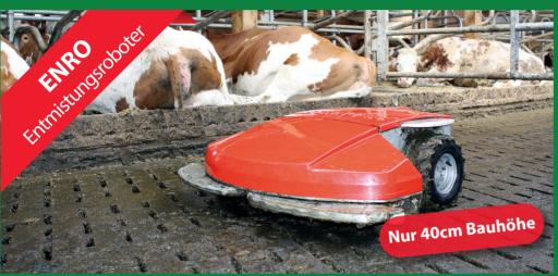
Automatische Entmistung für Spaltenböden im Rinderstall
