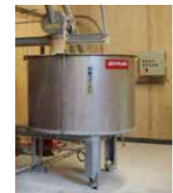
Cuve d'ensilage de maïs humide. Volume de 500 à 8 000 litres.
